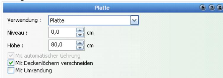
Verwendung: Wählen Sie aus den vier Möglichkeiten aus, ob die Platte als Platte, verschnittene Platte, Aussparung oder Materialbereich eingegeben werden soll.
