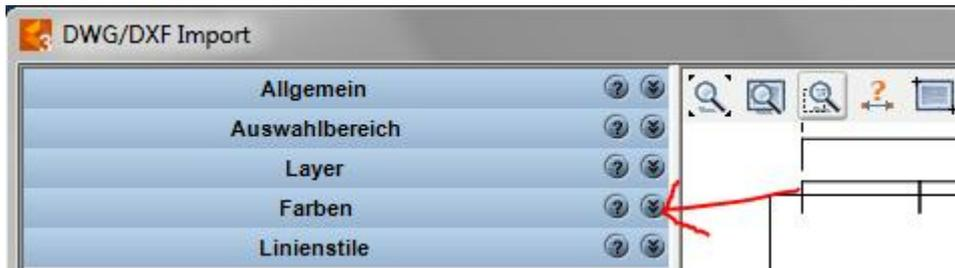
Wichtig ist eine Überprüfung der Farben, da einige CAD-Systeme mit weißen Linien auf schwarzem Hintergrund arbeiten, die auf dem weißen CasCADos-Hintergrund nicht sichtbar wären. In diesem Fall ordnen Sie der weißen Farbe per Klick auf die Fläche eine beliebige andere Farbe zu:
